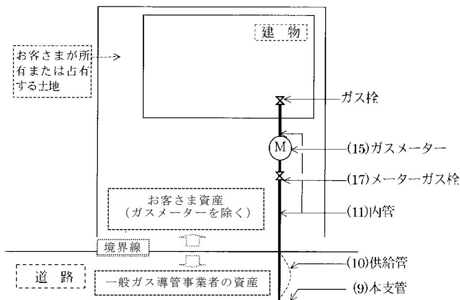
(12) 「ガス遮断装置」 … 危急の場合にガスを速やかに遮断することができる装置をいいます（ガスの供給確保のため本支管に設置されるバルブを含みません。）。
